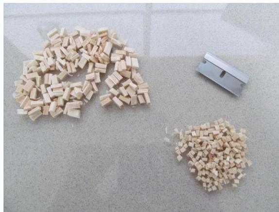
**Figure 13** Photographie illustrant la découpe grossière, en haut à gauche, et la découpe fine, en bas à droite
