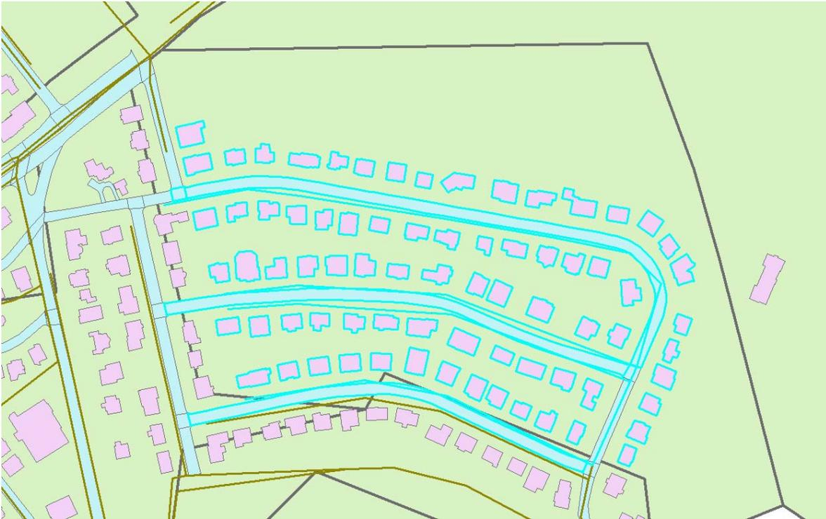
Figure 10 - Sous-bassin 1580 (les rues, conduites et bâtiments pris en compte apparaissent en cyan sur cette figure)
