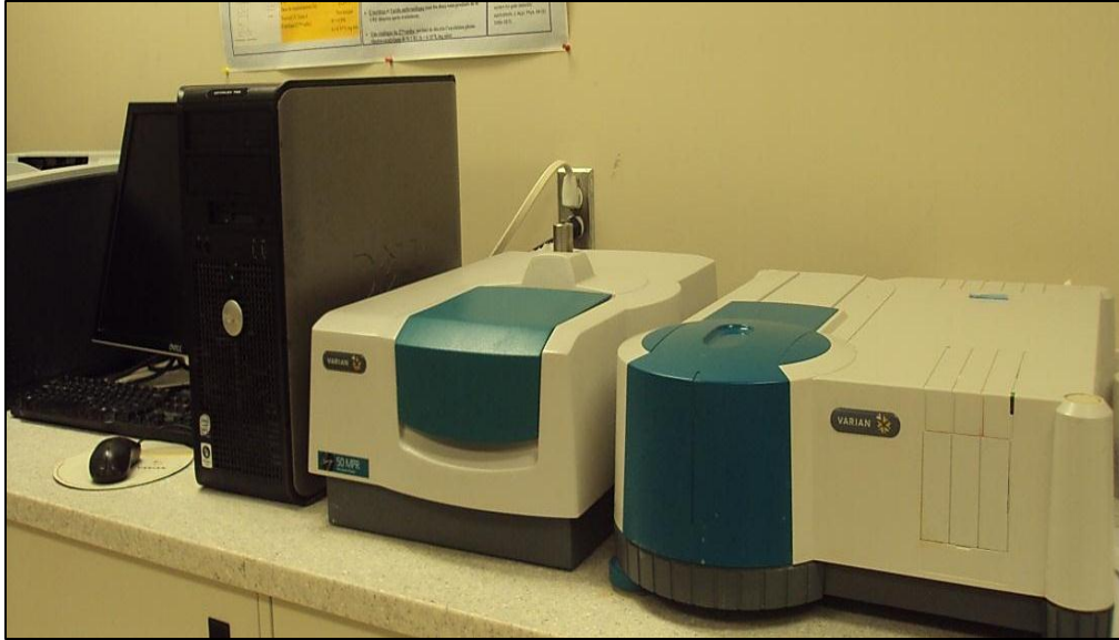
Figure 28 : Photographie du spectrophotomètre UV-visible utilisé pour quantifier la CBZ
