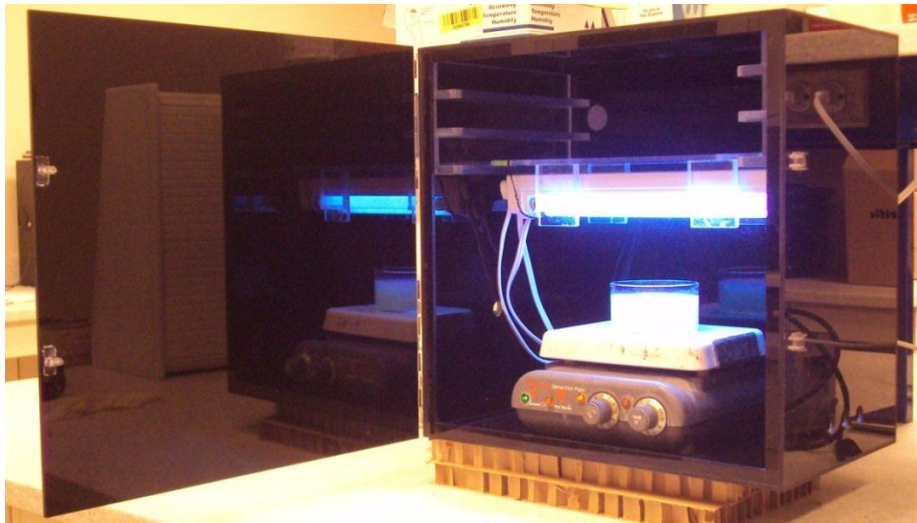
Figure 25 : Réacteur utilisé comprenant les trois lampes, la plaque agitatrice et le mélange réactionnel
