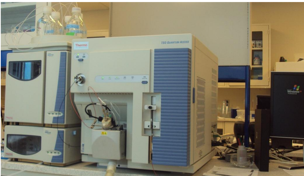
Figure 29 : LC-MS-MS utilisé lors de ces travaux pour des dosages de CBZ et de ses sous-produits
