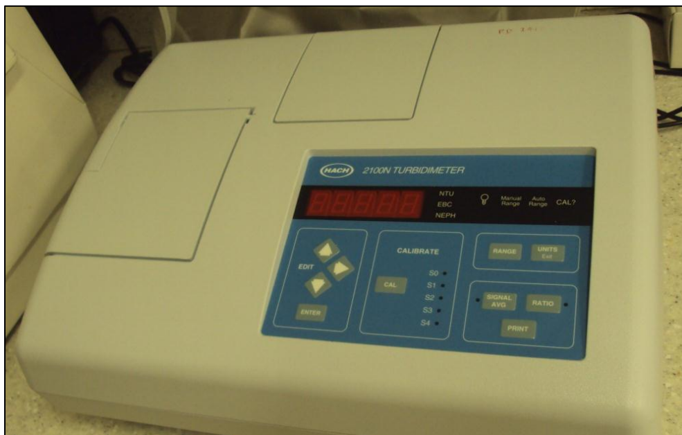
Figure 27 : Turbidimètre HACH utilisé pour les mesures de turbidité lors de l'évaluation du procédé optimisé sur les effluents
