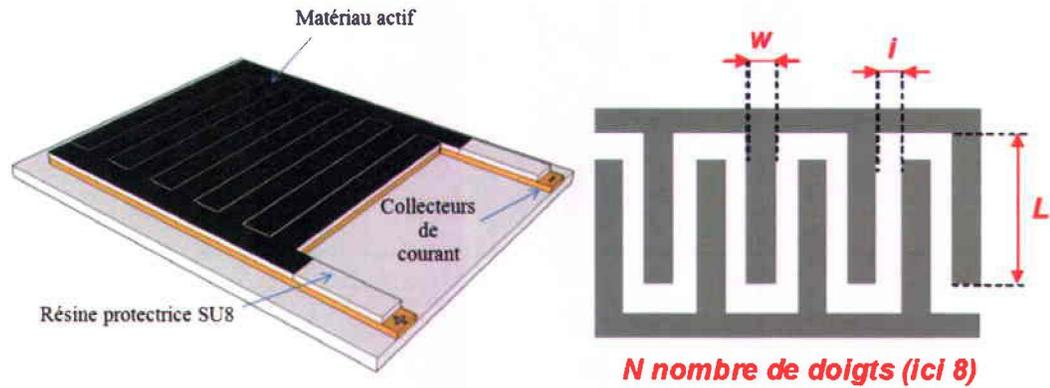
Figure 2: (À gauche) Schéma du microdispositif planaire interdigité visé par la présente étude. (À droite) Identification des quatre paramètres ( $N$ ,  $i$ ,  $L$  et  $w$ ) géométriques des microdispositifs,
