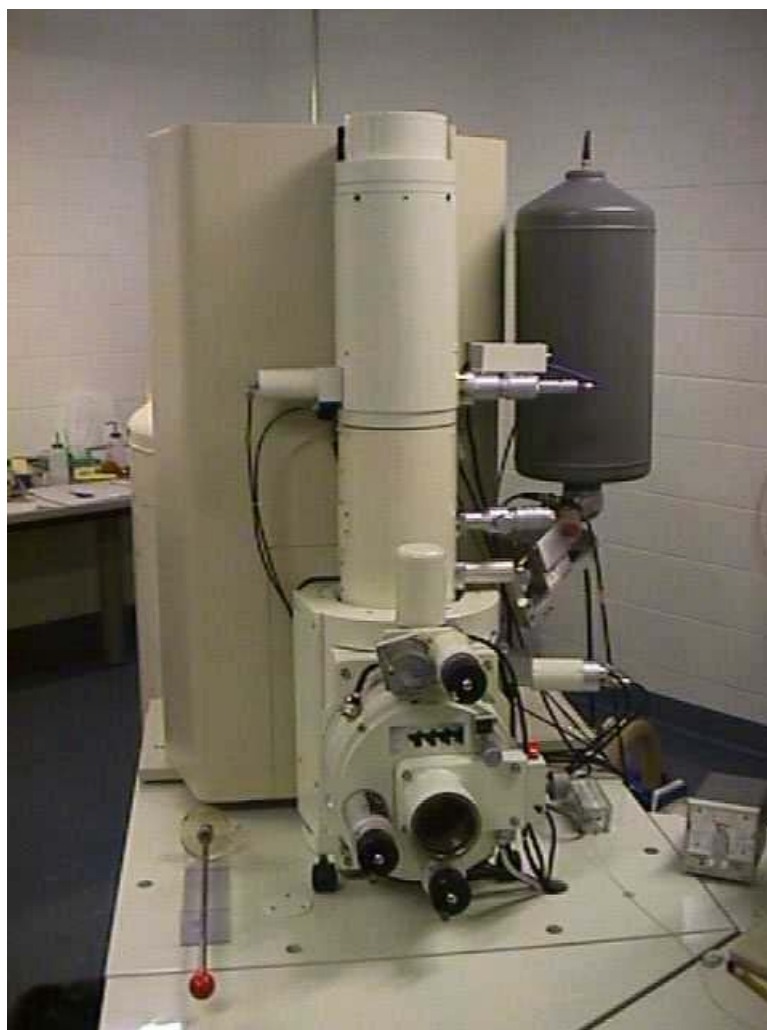
Figure III-5 : microscope électronique à balayage JEOL utilisé à l'INRS-Énergie et matériaux
