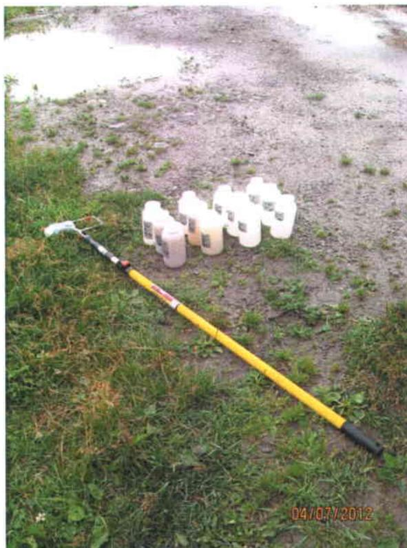
Figure A. 2 : Perche et bouteilles pour l'échantillonnage
