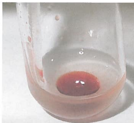
Figure 16. Problème de solubilité rencontré lors de la suspension des résidus dans l'eau : acétonitrile (50% v/v), 20 mM TEA, suite à l'évaporation complète de la phase d'acétate d'éthyle.
