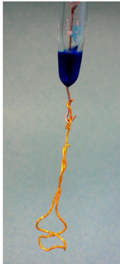
**Figure 3-5.** Pastille de catalyseur pressé sur matrice de titane et soutenue par un fil d'or lors de son montage en électrode.
