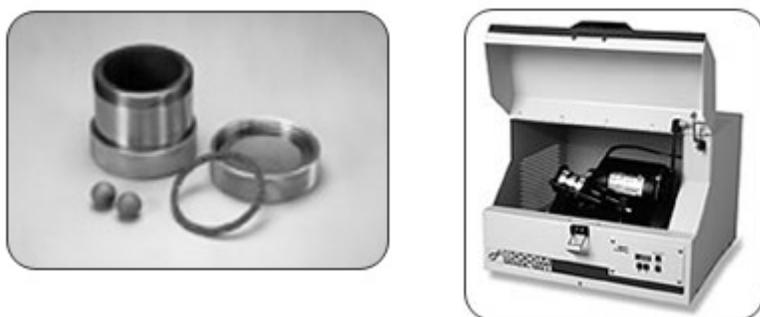
**Figure 3-1.** Photographies du creuset et des billes (à gauche) et du broyeur mécanique Spex 8000M (à droite) utilisés pour la mécanosynthèse des catalyseurs [1].
