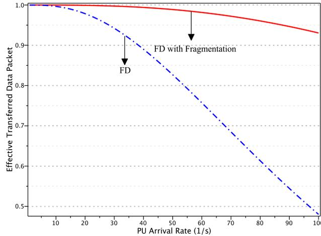
Figure 7.3: La fraction des données moyenne qui est transmise avec succès sur le canal avant la première arrivée d'PU,  $\bar{F}_T$ .
