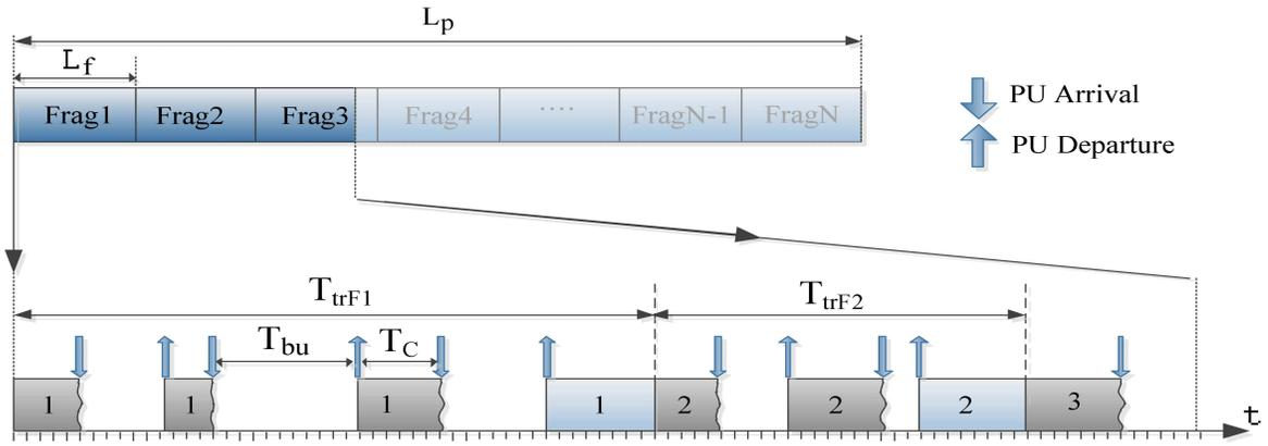
Figure 7.1: Fragmentation des paquets et sa transmission sur le canal.
