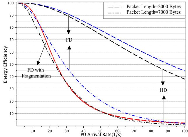
Figure 7.4: Rendement d'énergie pour les longueurs de données de 2000 et 7000 octet; HD contre. FD avec ou sans fragmentation.
