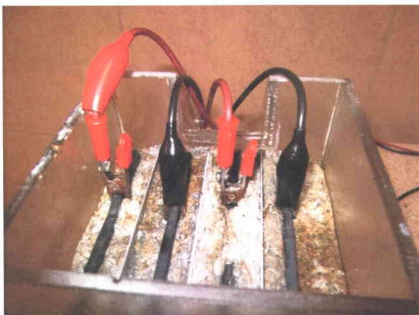
**Figure 23 Effluent de restaurant au cours du traitement par EC/électro-oxydation**
