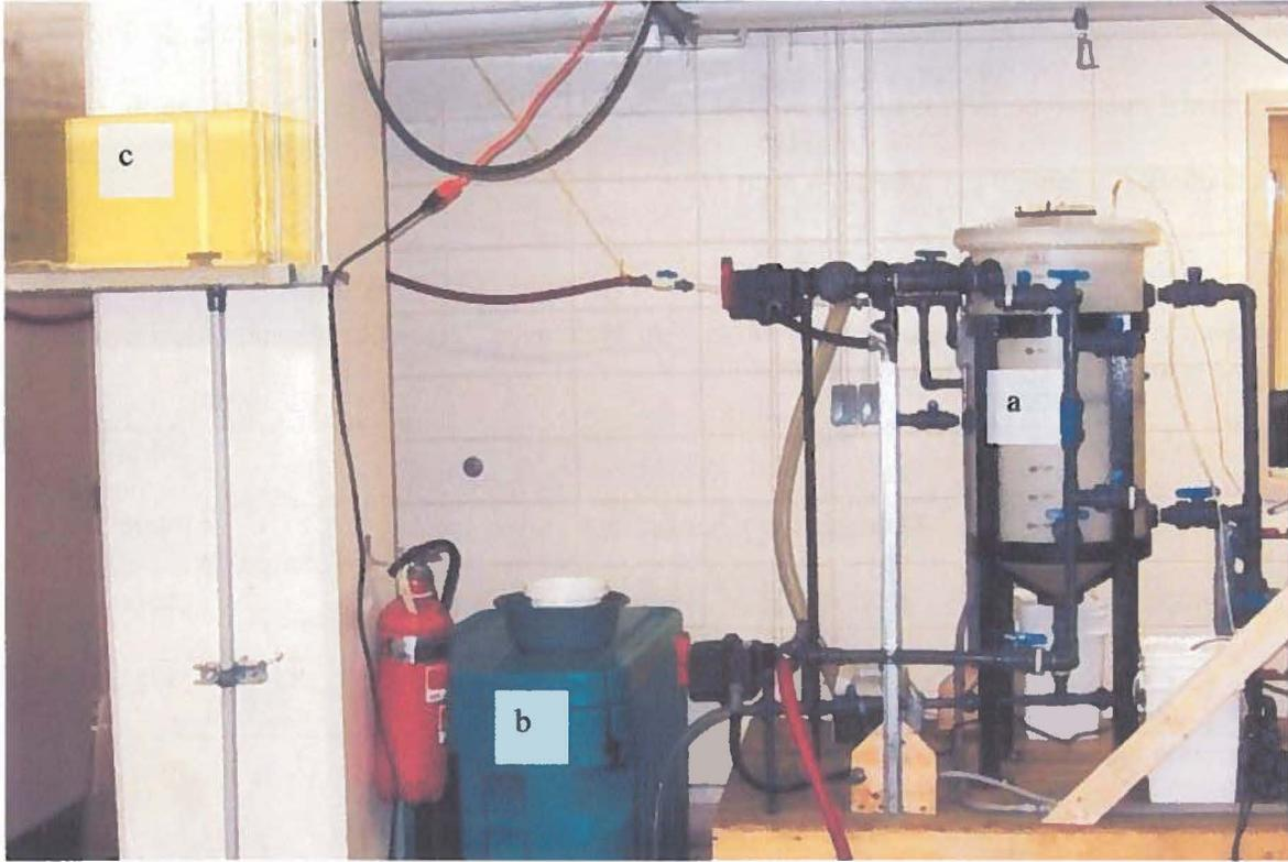
Figure 2.7 : Photographie du réacteur au LARSA. Le réacteur (a) a été approvisionné par un affluent venant de la cuve c. Le concentrat était dans le bac de concentrat (b) (J. Restrepo *et al.*, 2009).
