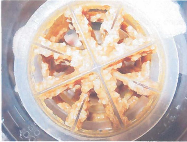
Figure 2.5 : Medium de plastique Cascades-1A® (Koch-Glitsch, Wichita, Kansas) avec de la biomasse. Le diamètre du médium est de 5 cm.
