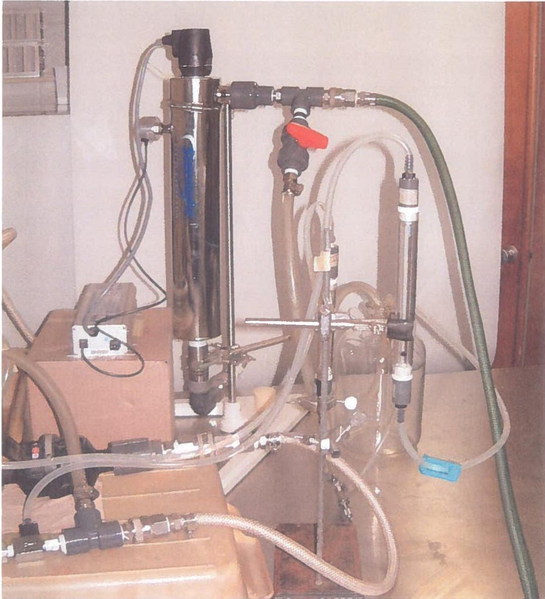
Figure 6a : Photo du banc d'essai d'un réacteur UV Sterilight Platinum SPV6.
