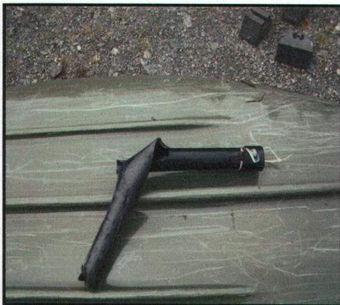
**Figure 4-22 : Tube plié suite à la pression exercée par le couvert de glace au lac Ébron**
