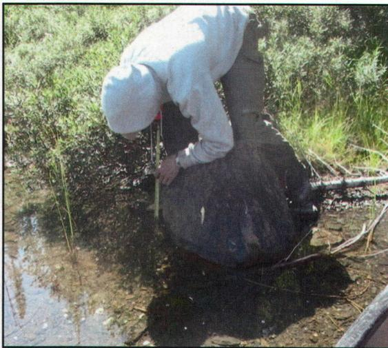
**Figure 3-11 : Mesure de la hauteur de la surface d'eau par rapport au repère fixe au lac au Foin**
