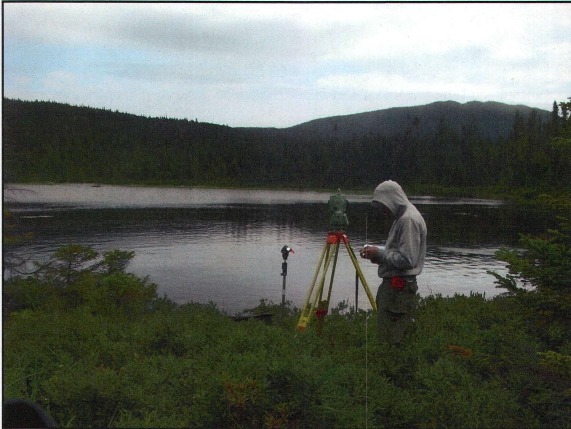
**Figure 3-13 : Levé bathymétrique à l'aide d'une station totale**
