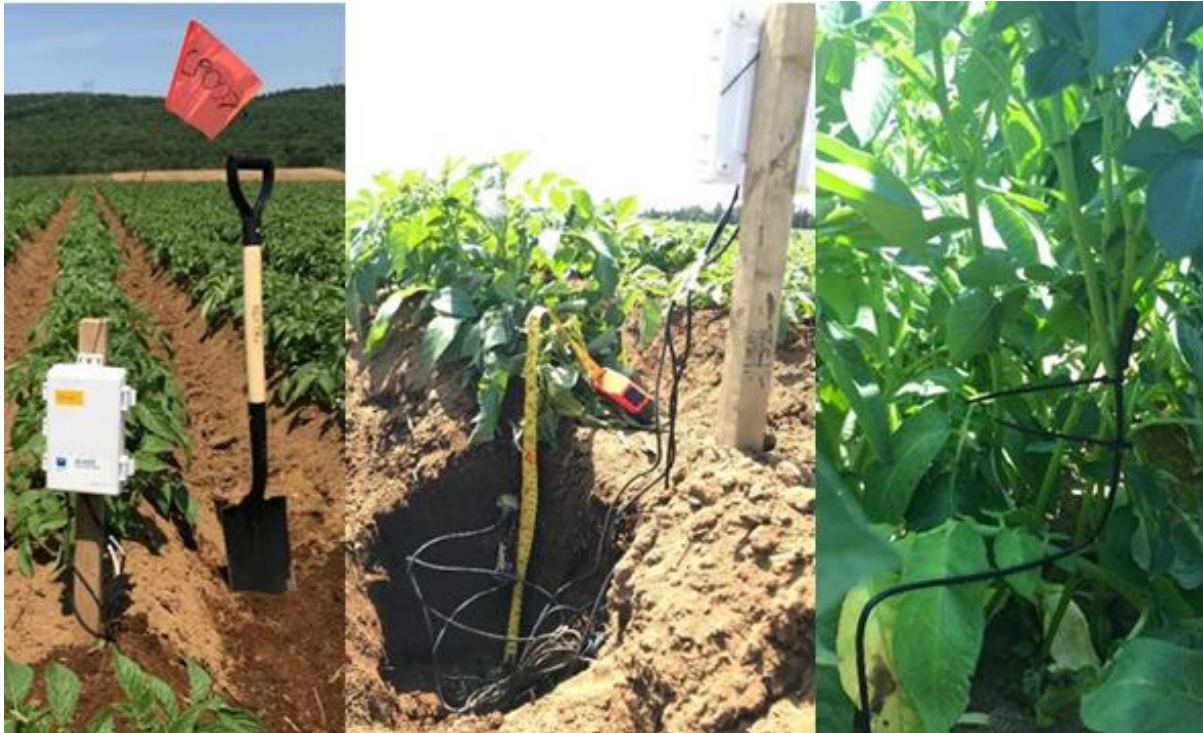
Figure 8: Dispositif d'acquisition des données in situ — à gauche : enregistreur de données; au centre : sondes d'humidité et de température du sol; à droite : sonde de température de la canopée.
