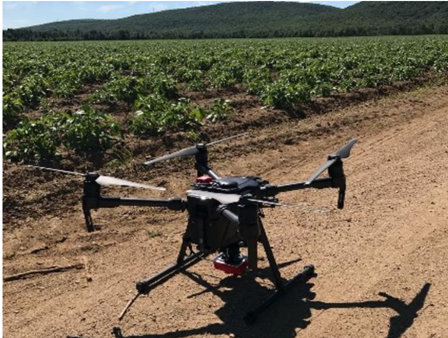
Figure 10 : Drone utilisé lors de l'obtention des images thermiques.
