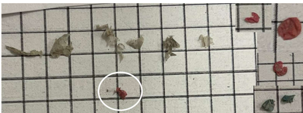
Figure 21 Pellicules de plastique vides pour le pelliculage des graines et d'engrais retrouvées dans les carottes de sol du champ 4
