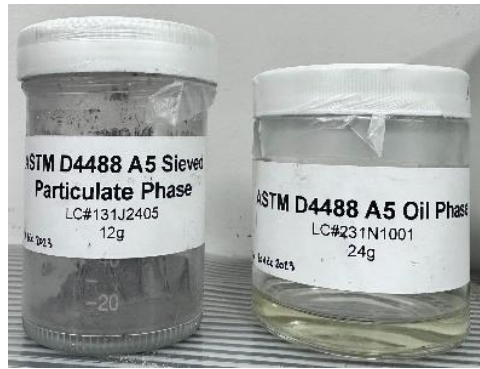
Figure 9 Phase liquide et phase en poudre des saletés utilisées dans le test d'enlèvement des taches selon le guide ASTM D4488
