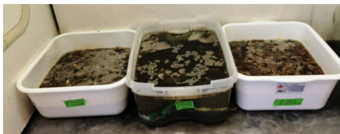
Figure 5.1 Coloration noirâtre découlant du trempage de la poudre de pile dans la solution saline
