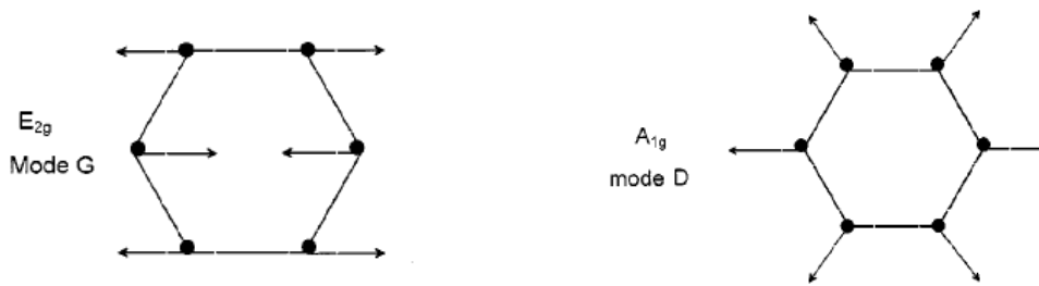
Figure A.3 : À gauche, géométrie de vibration du mode E_{2g} (mode G) dans le plan de graphène et à droite, celui du mode A_{1g} (mode D)
