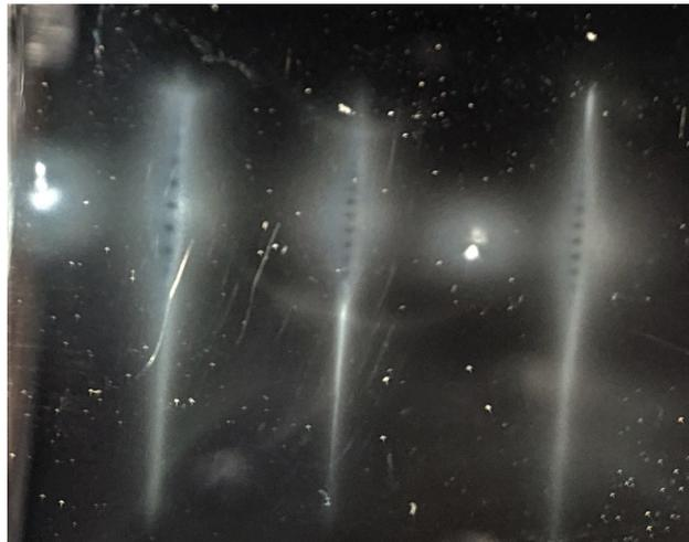
FIGURE 4.3 : Traces de nanoparticules de  $SiO_2$  de 100 nm incrusté dans un Gel-Box<sup>TM</sup> lors de la déviation d'un faisceau par un champ électrique. (Tension respective de gauche à droite :0V,-440V,-310V,0V,280V)
