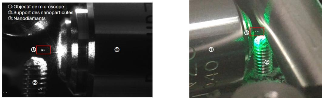
FIGURE 1.11 : Deux nanodiamants en lévitation optique à deux positions distinctes
