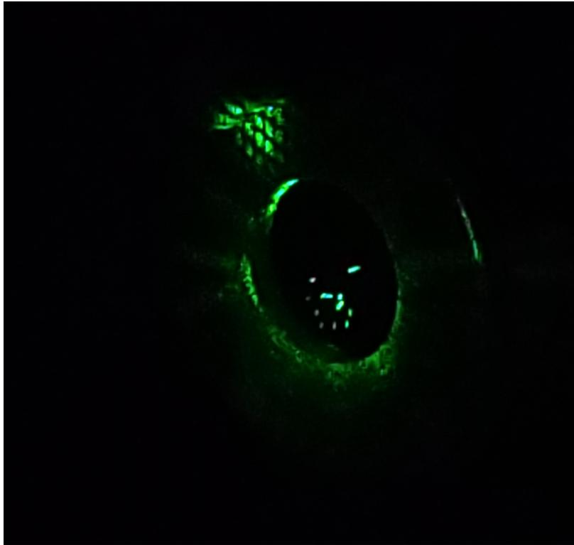
**FIGURE 2.6 : Plusieurs spores de Lycophytes chargés piégés dans un piège d'ions**
