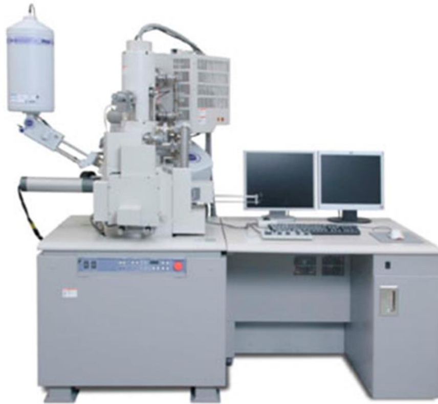
Figure 7 : Appareil de MEB utilisé pour l'analyse des surfaces métalliques
