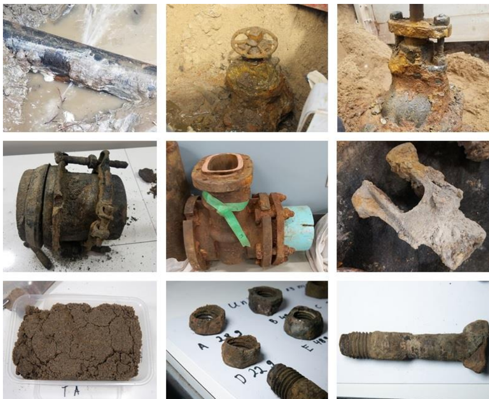
Figure 4 : Exemples d'échantillons prélevés sur des composants détériorés et sur le sol environnant à la ville de Québec
