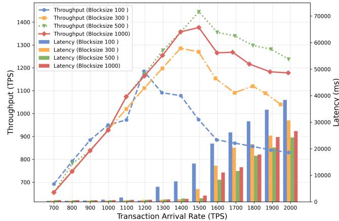
Figure 1.6: Performances de la blockchain avec des tailles de bloc variant de 100 à 1000 transactions par bloc.
