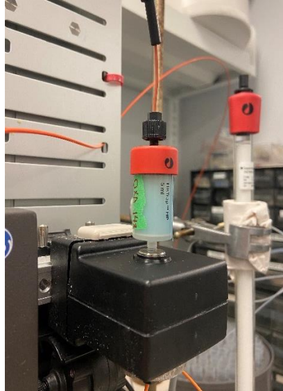
Figure 3.2: Colonne His-Trap™ HP de 5 ml utilisée pour toutes les purifications de l'OXA-143 et de son mutant P227S.
