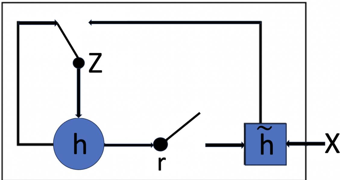
FIGURE 3.4 : GRU Cells Structure.
