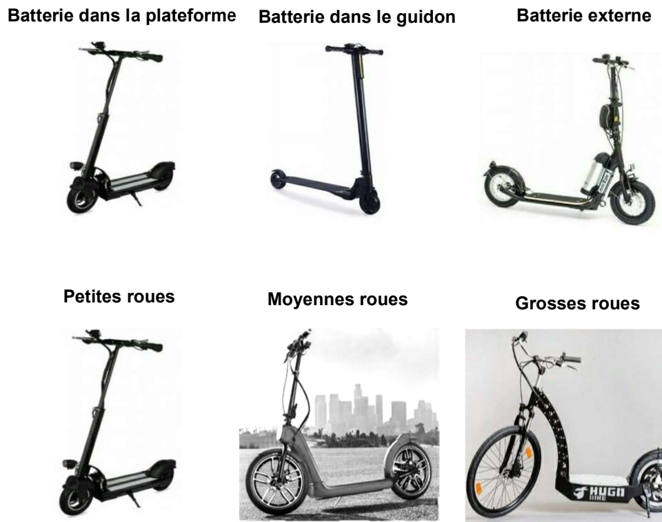
Figure 2 : Exemples de trottinettes électriques selon l'emplacement de la batterie et la taille des roues
