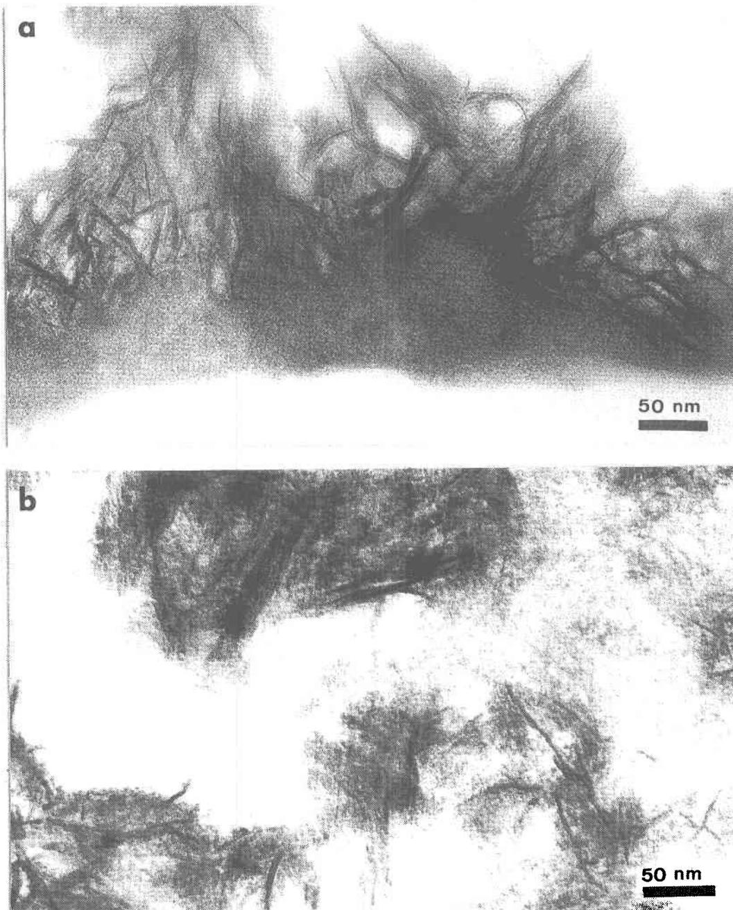
**Figure 5.7:** Lépidocrocite synthétique déposée sur un collecteur de Teflon (a) et précipitée librement (b). Noter la similarité entre la forme et la taille des aiguilles des 2 échantillons.
