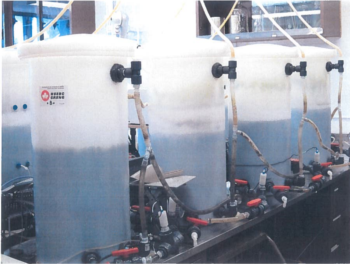
Figure 3.9: Photo du MBBR de la série B. Des récipients d'un volume de 30 L furent installés sur une paillasse de laboratoire. Un système de circulation et recirculation fut posé reliant chaque MBBR par de la tubulure flexible. Des sondes à pH furent installées à la base de chaque récipient afin d'évaluer à temps réel le pH dans chaque réacteur. Finalement l'aération et le mélange des supports dans les réacteurs furent faits par l'entremise d'une pompe à air installé au fond de chaque réacteur (à l'exception du réacteur anoxique où un mélange mécanique fut fait).
