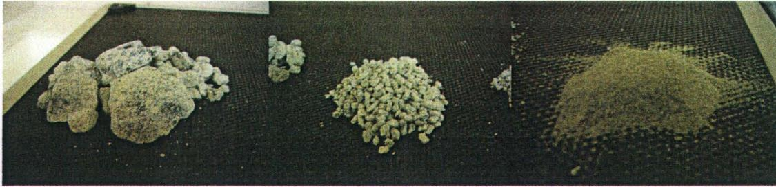
**Figure 12** Photos montrant différentes fractions composant les REC. Noter que des fragments encore plus volumineux peuvent s'y retrouver
