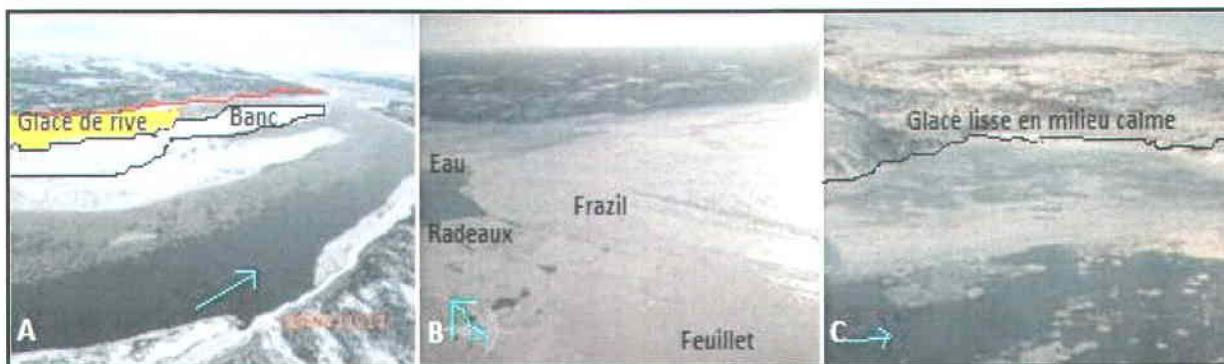
Figure 3.11 Photos aériennes illustrant (A) la croissance de la glace thermique en feuillet au droit d'un banc émergeant superposée d'une mince couche de neige; (B) une couche mince ceinturée de strates parallèles composées de frazil, de radeaux coalescents et d'eau libre en amont; (C) un estran protégé en aval de Kuujuaq (rive ouest) recouvert de glace lisse homogène.
