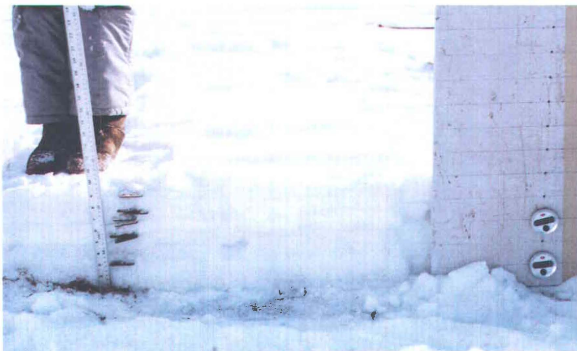
FIGURE 1.6: Un profil vertical de la température.
