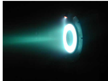
Propulseur à effet Hall (moteur plasma) de 2 kW du Princeton Plasma Physics Laboratory [8].
