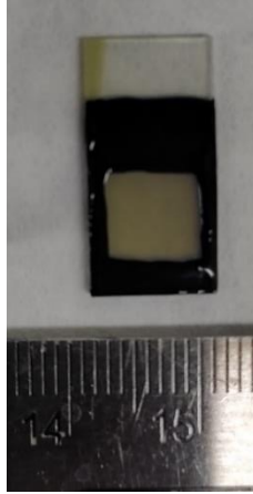
Figure 3.1 : Photo d'un échantillon de \text{BiVO}_4 couvert d'époxy pour les mesures photo-électrochimiques. La partie haute et transparente de l'échantillon est le FTO laissé à nu ; la partie centrale non-couverte est la partie de la couche mince de \text{BiVO}_4 qui est exposée au rayonnement lumineux
