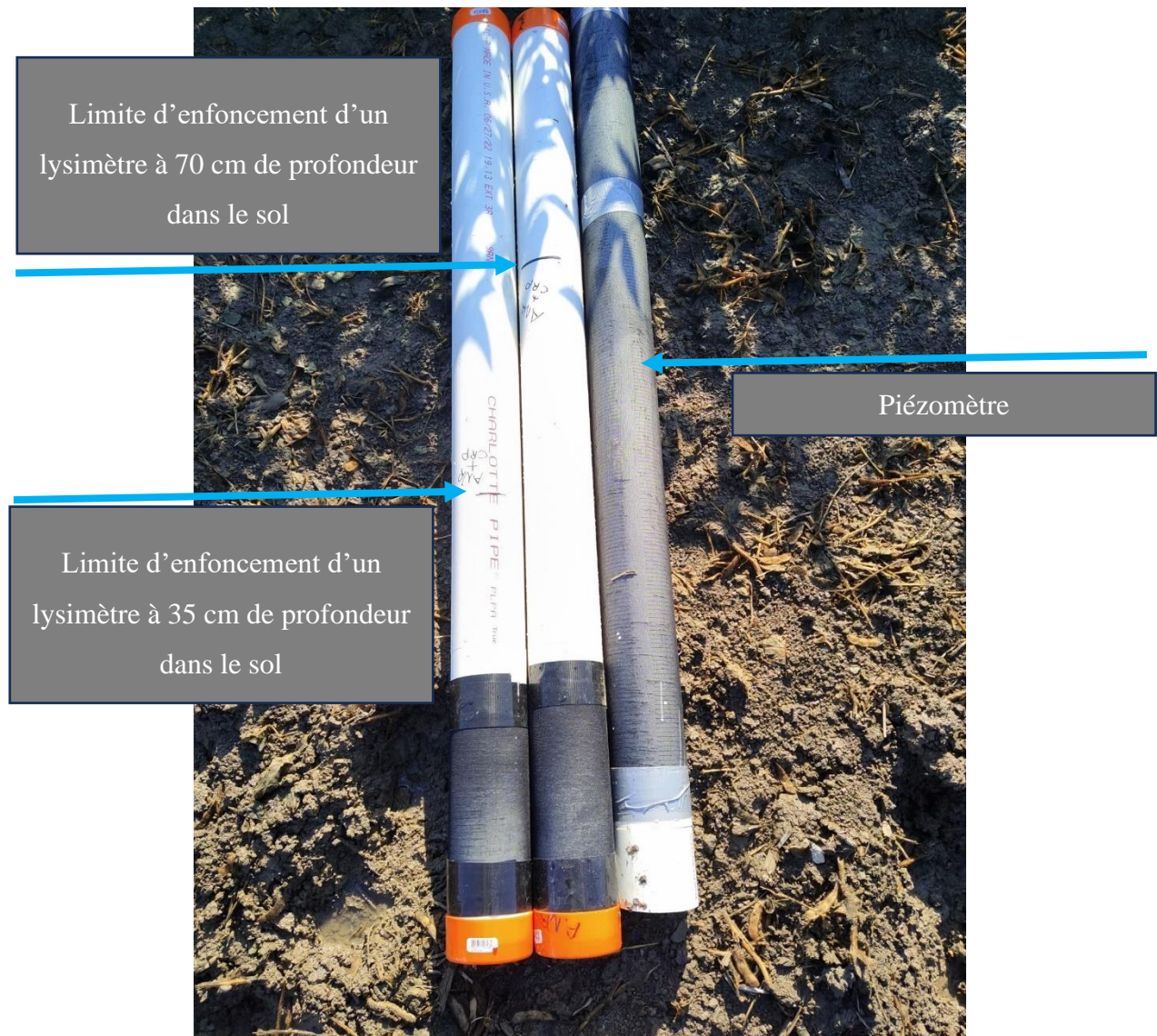
Figure 44 - De la gauche vers la droite : lysimètre de 35 cm de profondeur, lysimètre de 70 cm, piézomètre
