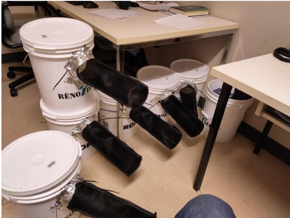
Figure 43 - Collecteurs de surface
