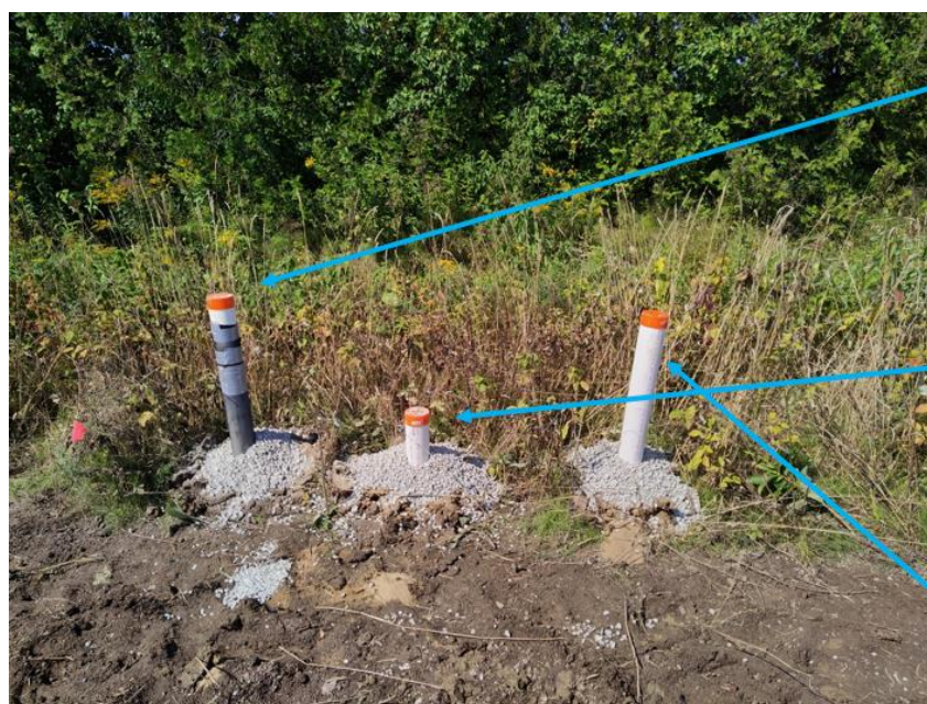
Figure 49 - Forage pour mise en place des lysimètres et piézomètres
