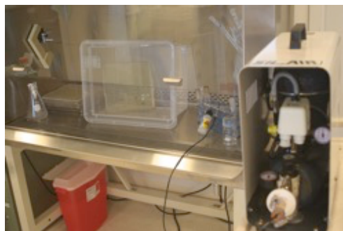
Figure 3.6. Dispositif complet du bacteriospray . Les boîtes de Pétri de 20x20 \text{cm}^2 utilisées pour le criblage fonctionnel étaient entourées d'une boîte en plastique pour limiter les aérosols émis par l'aérographe.
