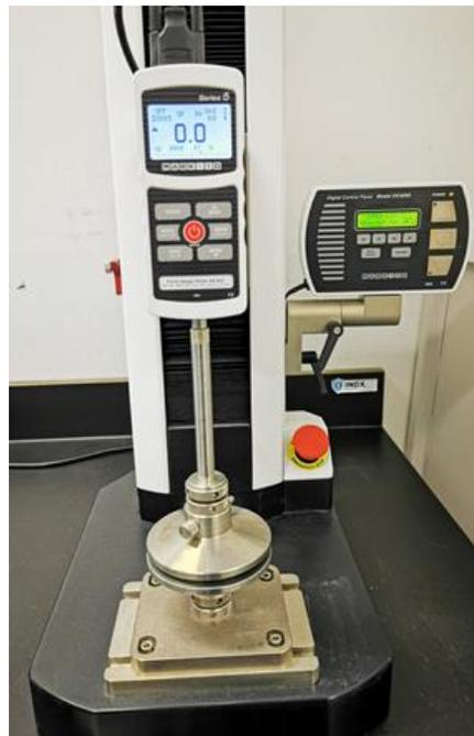
**Figure 16**      **Dispositif de compression**
