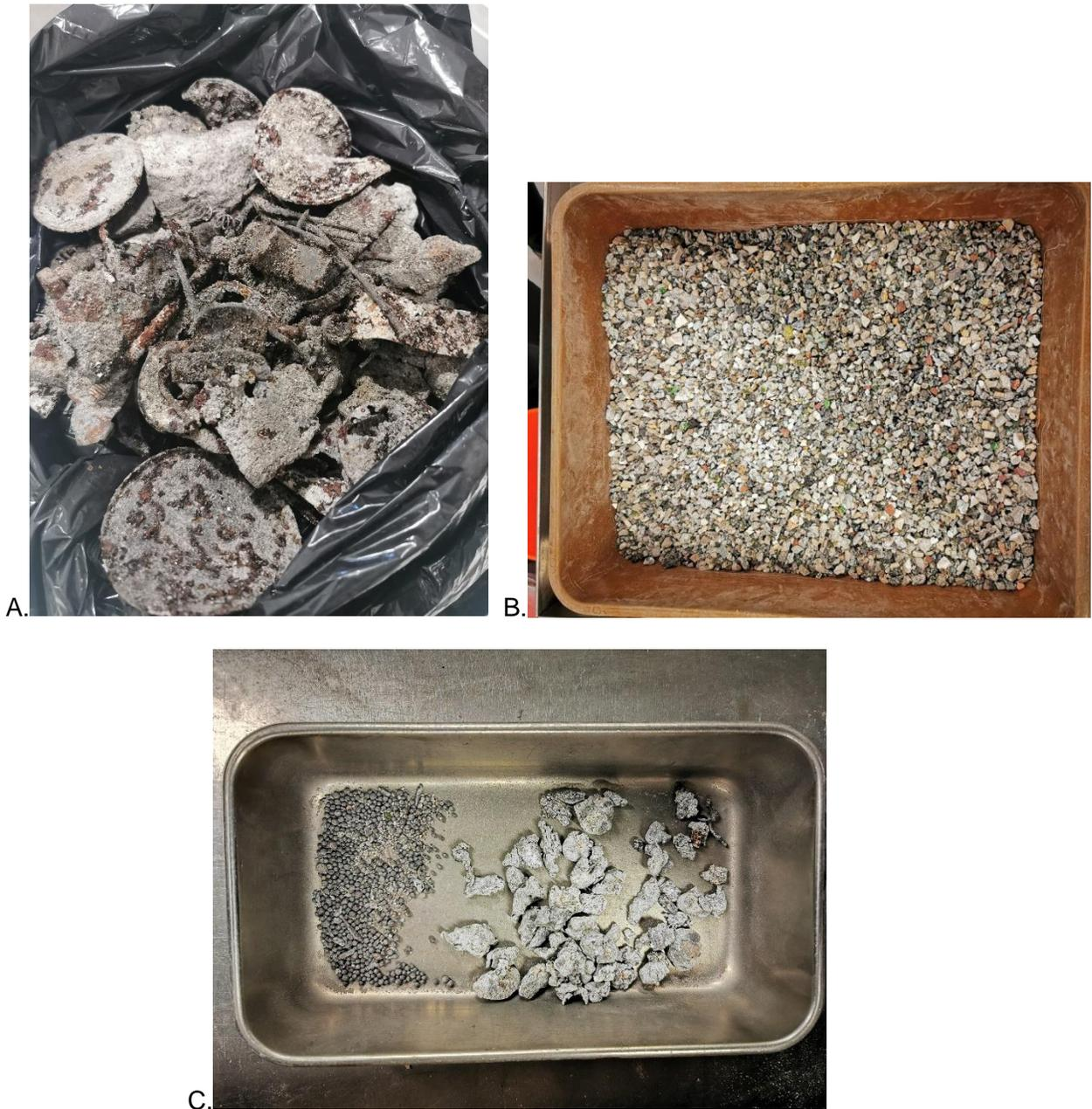
**Figure 19** Fractions non broyées A : morceaux de ferrailles et imbrulés, B : fraction non broyée issue du broyeur rotatif, C : Aluminium et billes de fer trouvés dans B.
