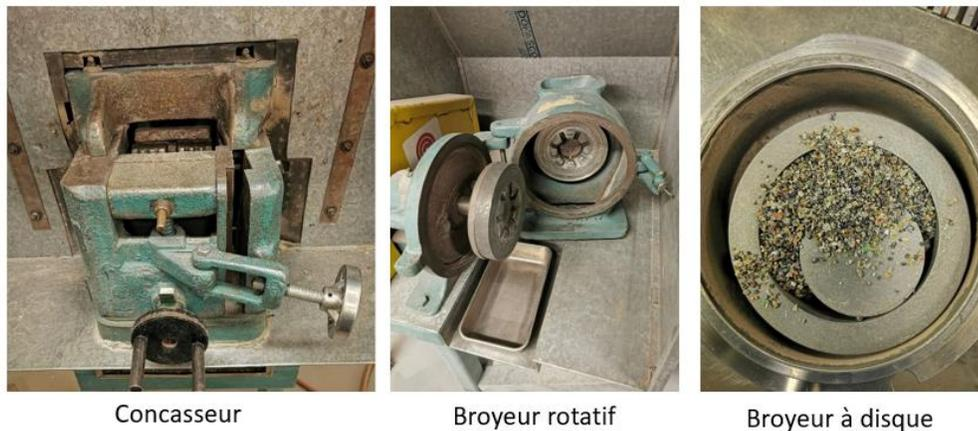
**Figure 11 Broyeurs utilisés lors des étapes de broyage**
