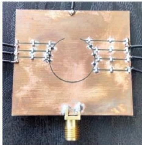
**Figure 20 Antenne reconfigurable à fentes semi-circulaires agiles en fréquence (Kumar, 2016)**
