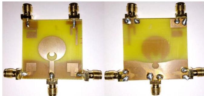
Figure 26 Systèmes d'antenne ULB et bande étroite intégrée à cinq ports (Nella, 2018)
