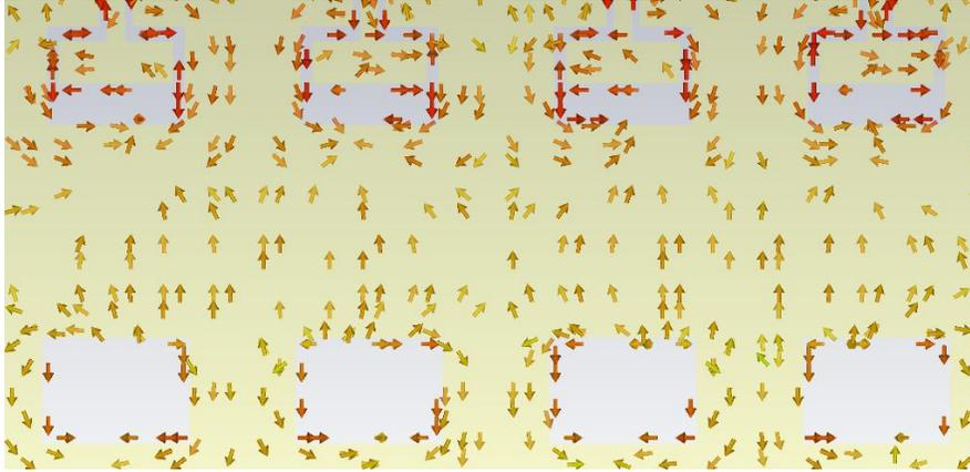
Figure 60 Courants de surface dans le réseau d'antennes à 28 GHz
