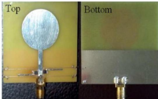
**Figure 22 Antenne ULB et bandes étroites basées sur des commutateurs GaAs FET (Aboufoul, 2012)**
