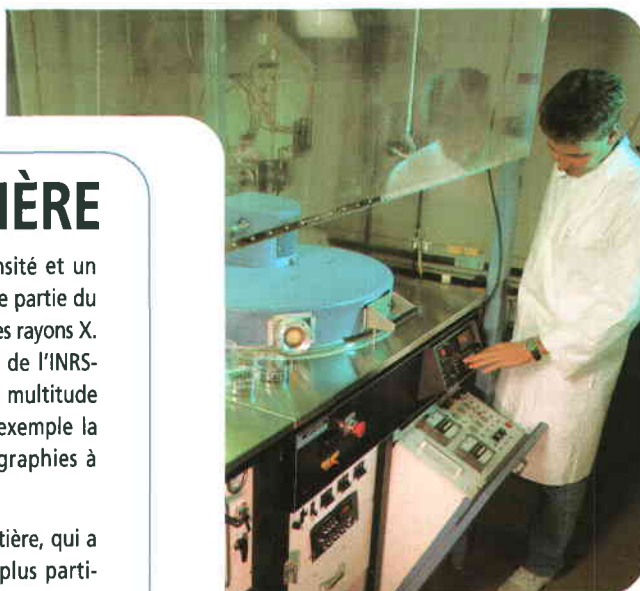
Utilisation d'un réacteur à plasma pour le développement de couches minces requises en microélectronique.
