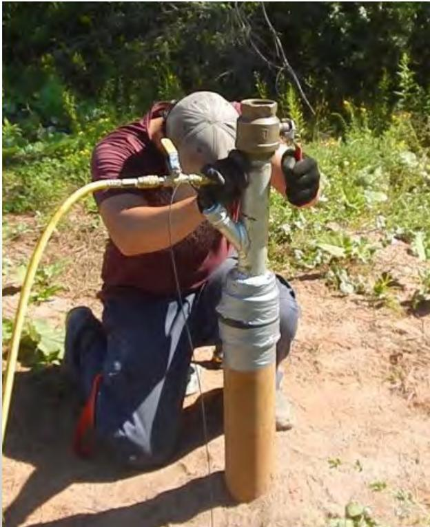
Essais de perméabilité (slug tests) à l'azote comprimé permettant d'évaluer la conductivité hydraulique
