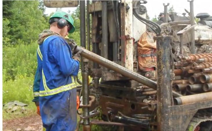
Forage au diamant permettant la récupération de carottes de roches
