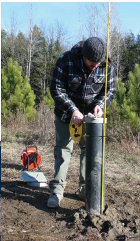
Mesure du niveau piézométrique sur le terrain.
