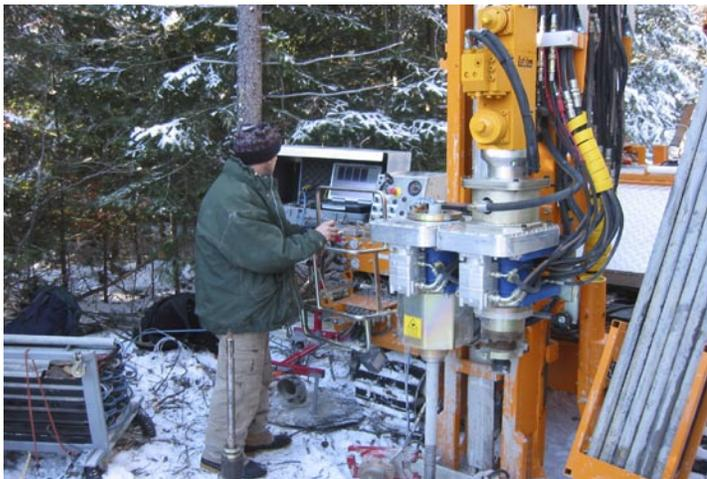
Réalisation d'un essai de pénétration au cône (CPT) par Jean-Marc Ballard en bordure de l'esker Saint-Mathieu/Berry dans la région d'Amos. En médaillon, vue d'ensemble du système de sondage.
