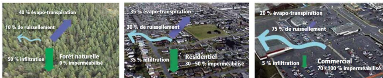
Figure 5.3 : Impacts de l'occupation du sol sur le bilan hydrologique (ruissellement, infiltration et évapotranspiration)
