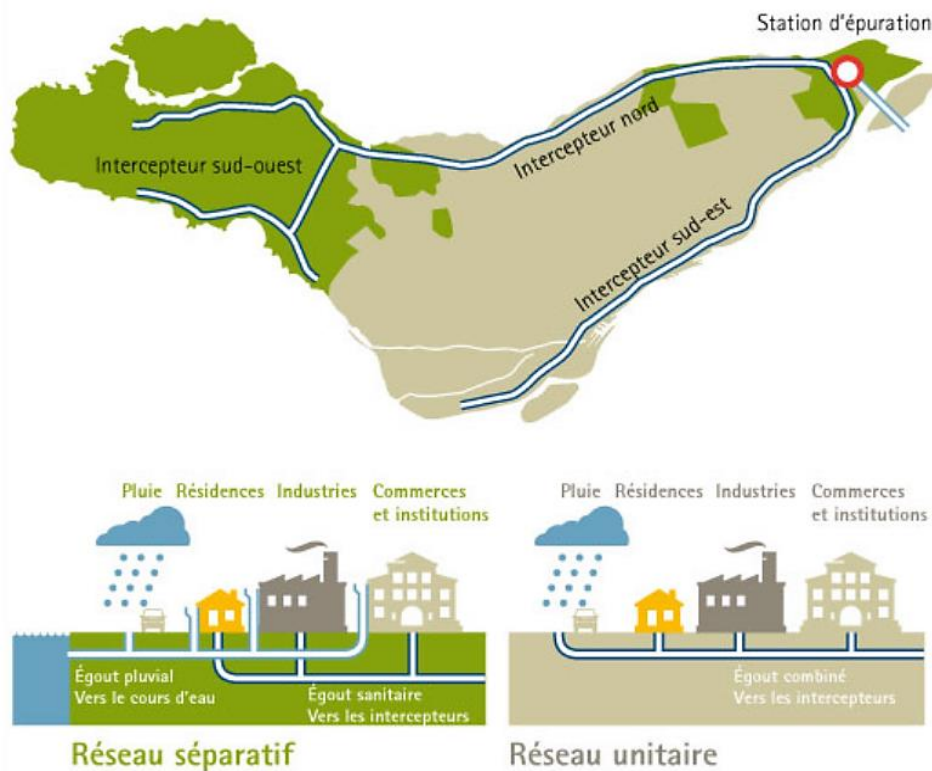
Figure 2.9 : Intercepteurs, station d'épuration et portions de l'île desservies par un réseau unitaire et par un réseau séparatif
