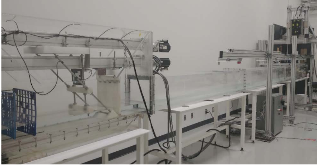
Figure 3.1 Petit canal à houle (INRS, LHE-CT, espace Hydées) : section 30x30cm 2 , longueur 12m : batteur piston et absorbeur (à gauche) ; sondes à vagues, vélocimétrie laser (à droite)
