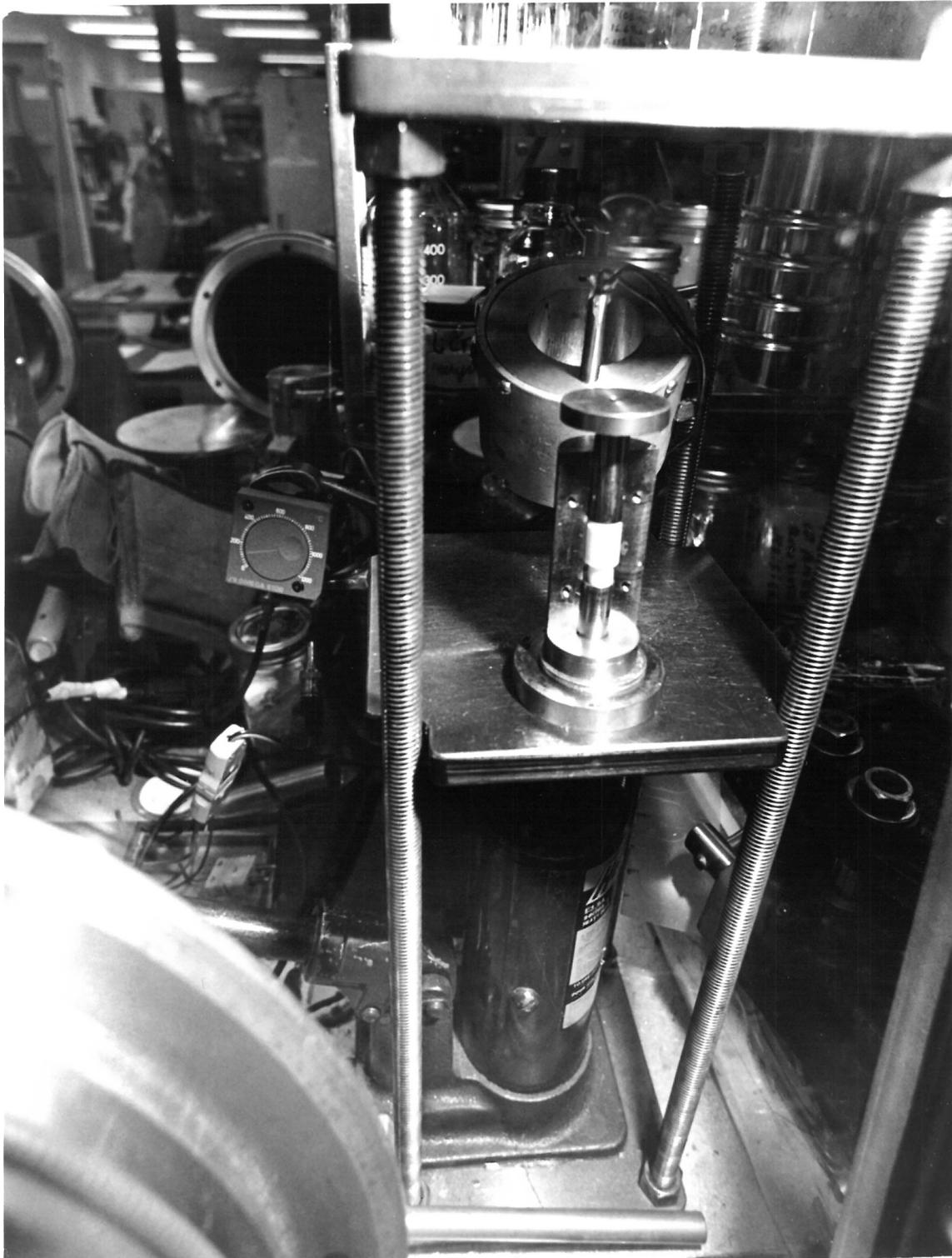
Figure I.2 Photographie du montage expérimental utilisé pour la mise en forme des matrices d'électrolytes, préalable aux essais de diffusion de radio-traceurs.
