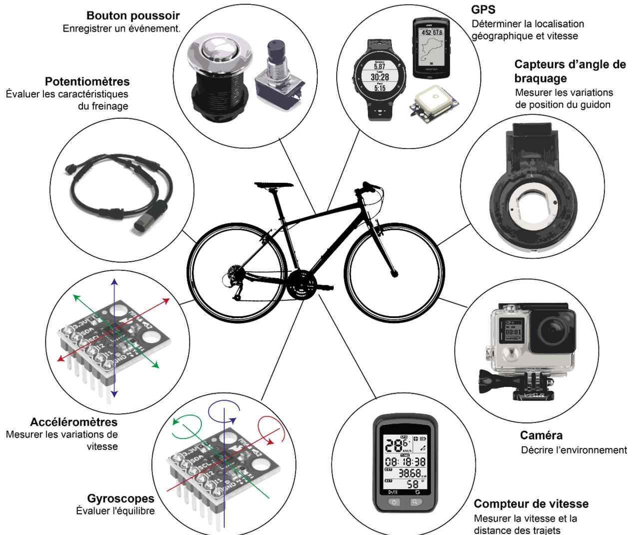
**Figure 1.1 :** Types d'appareils utilisés dans les études portant sur les vélos électriques
