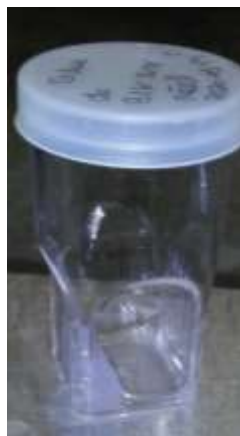
Figure 5.9 Composé gélatineux présent dans le lixiviat réel
