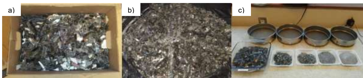
Figure 4.4 Caractérisation granulométrique des panneaux LCD : a) Panneaux LCD déchiquetés ; b) Quartage des panneaux LCD déchiquetés ; c) Panneaux LCD déchiquetés et tamisés
