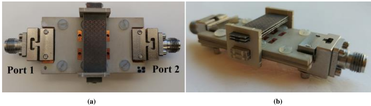
Fig. 7.17: Photographies d'une antenne dipôle ME à deux ports chargée avec une méta-lentille SRR, (a) vue de dessus, et (b) vue 3D, où les 3 couches SRR sont clairement indiquées.
