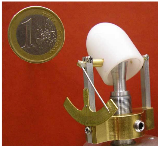
Fig. 1.2 : Antenne à lentille de direction de faisceau mécanique à 60 GHz [11].
