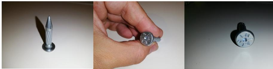
**Figure 2: Clou d'arpentage utilisé sur le terrain comme pseudo repère géodésique**
