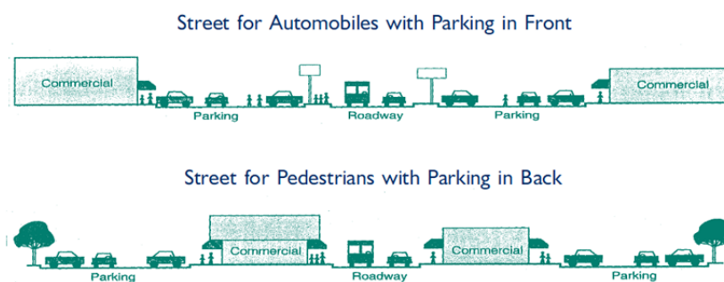
Figure 1 : Les différentes orientations de la rue (Ewing, 1999 : 10)
