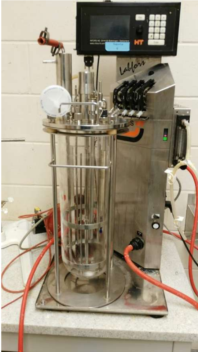
Figure 5: Fermenteur à 7L du laboratoire ETE
