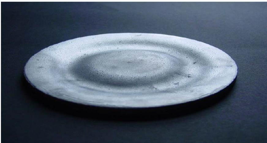
FIGURE 11 – Usure non uniforme d'une cible utilisée en pulvérisation magnétron. [67]
