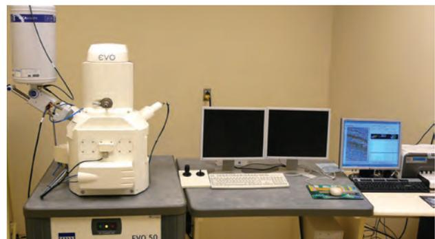
Microscope électronique à balayage (MEB)
